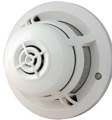
Извещатель ESMI 2251CTLE-W объединяет в себе 4 чувствительных элемента, выступая как одно устройство. Извещатель обнаруживает CO, контролируя продукты горения тлеющего пожара, инфракрасное излучение, измеряя уровни излучения окружения пламени, дымовой оптический и тепловой сенсоры.
