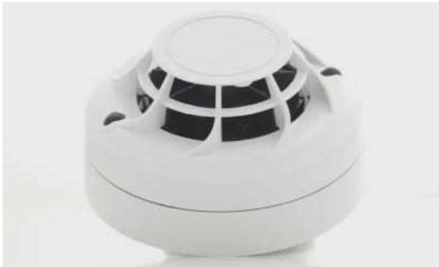
ESMI 52051E и ESMI 52051HTE являются адресно-аналоговыми тепловыми извещателями с фиксированной температурой, использующими термисторы и микропроцессорную технологию для быстрой реакции и линейного контроля температуры. Линейный контроль позволяет измерять температуры в диапазоне 58°C (Класс A1S) до 78°C (Класс BS).
